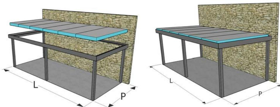
\* Dans le cas où la fixation murale peut poser problème, il est nécessaire de renforcer par une structure alu : poteaux + poutre
