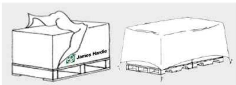
*L'humidité expose le panneau à des altérations irréversibles, notamment à l'apparition d'efflorescences.*
