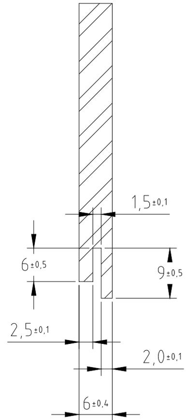
Figure 4 - Détail clin usinage
