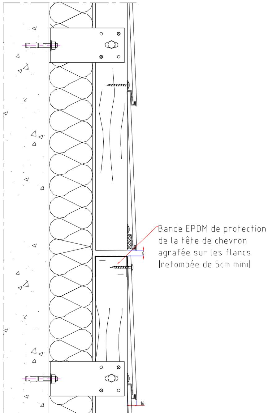
**Figure 12bis - Détail fractionnement ossature – Longueur des montants < 5,4 m**
