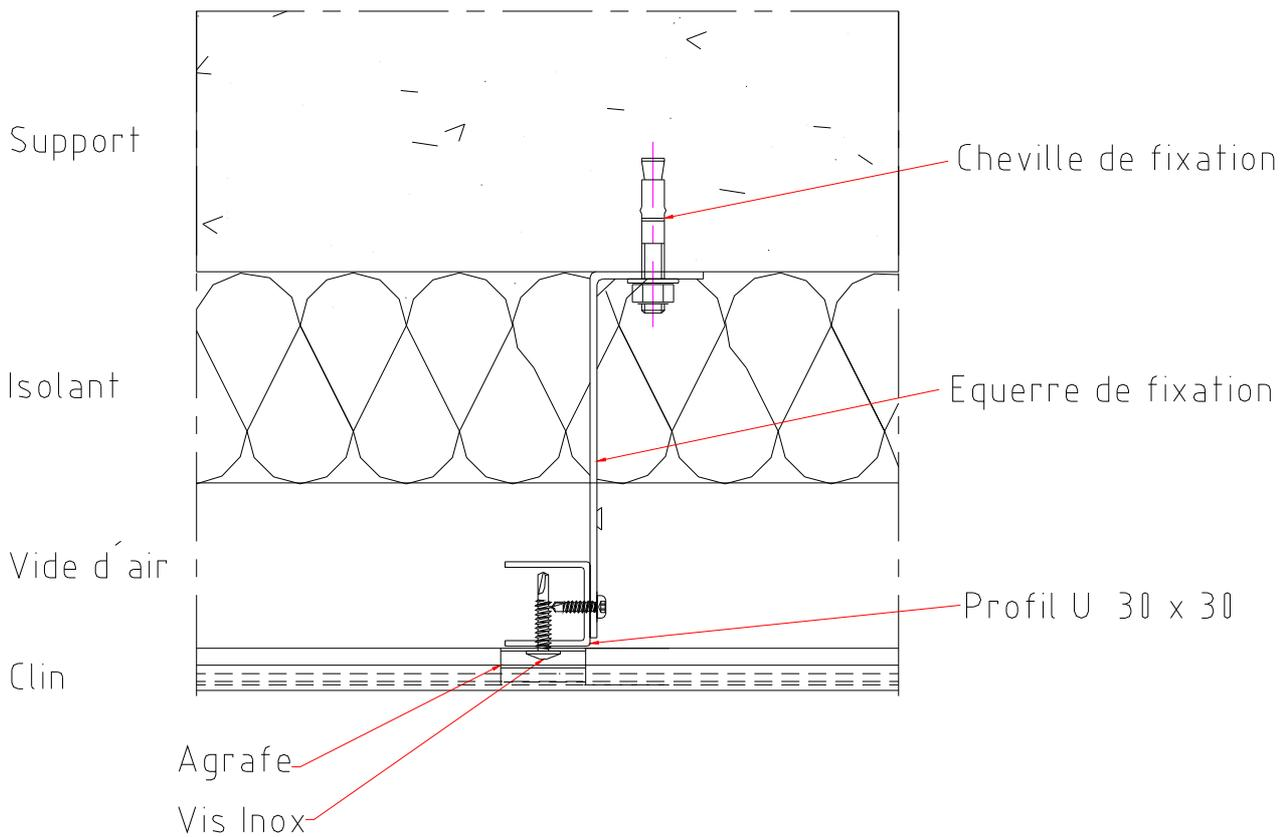
**Figure 29 - Pose sur ossature métal – Profil courant**
