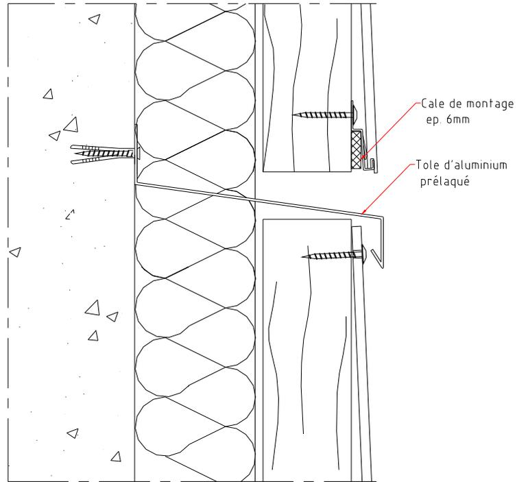
Figure 11 - Détail fractionnement de la lame d'air
