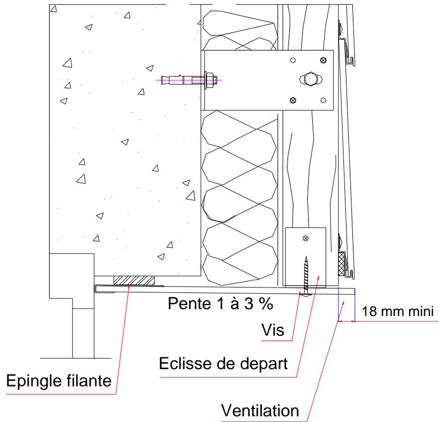
Figure 21 - Détail linteaux – Panneaux FUNDERMAX Exterior/ MAX UNIVERSAL
