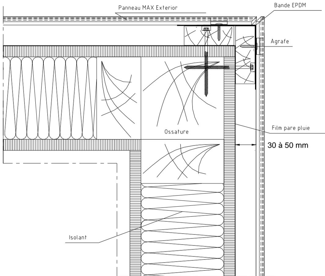
**Figure 33 – Angle sortant sur COB jusqu'à R+2**
