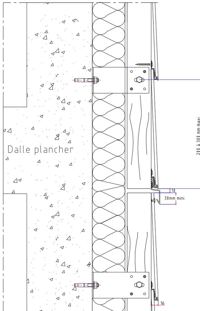
Figure 12 - Détail fractionnement ossature – Longueur des montants > 5,4 m
