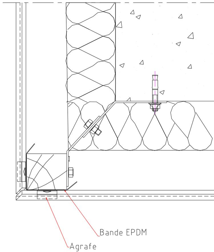
**Figure A2 – Détail angle sortant chant vue**
