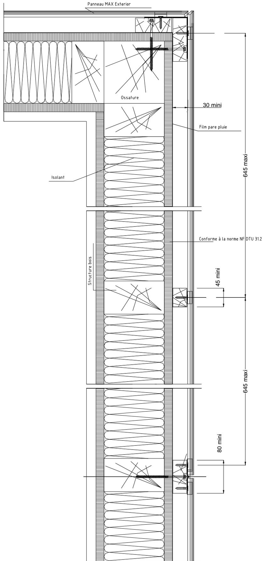
Figure 32 – Pose sur COB jusqu'à R+2
