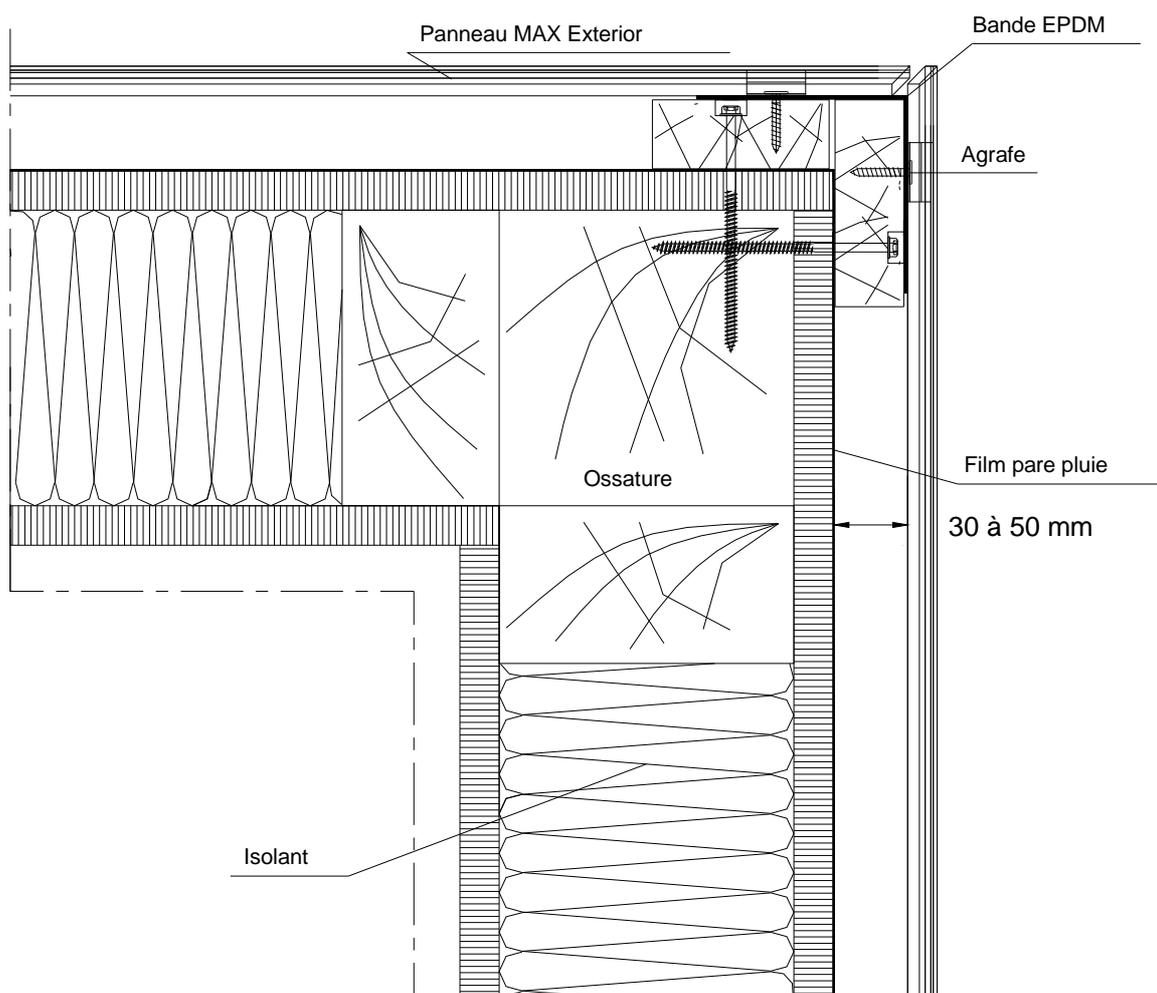
Figure B4 – Angle sortant – Pose sur COB
