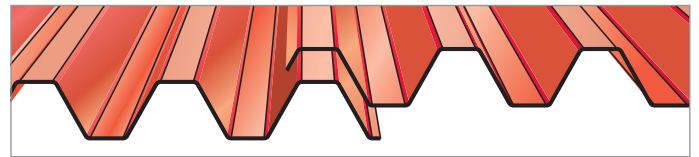
Sovrapposizione laterale di una greca con piedino di appoggio Lateral overlapping of a corrugation with support
