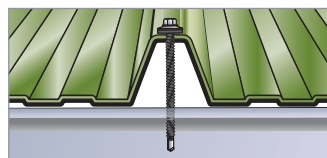
Fissaggio su metallo Fixing on metal
