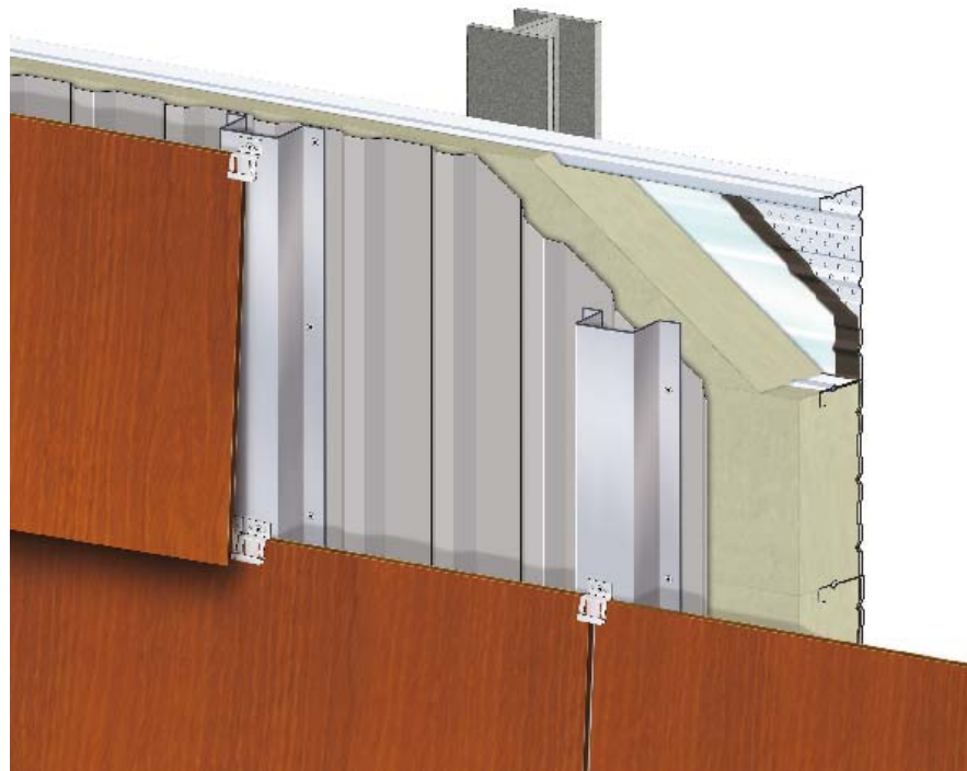
Figure 1 bis – Schéma de principe clins avec pare-pluie métallique
