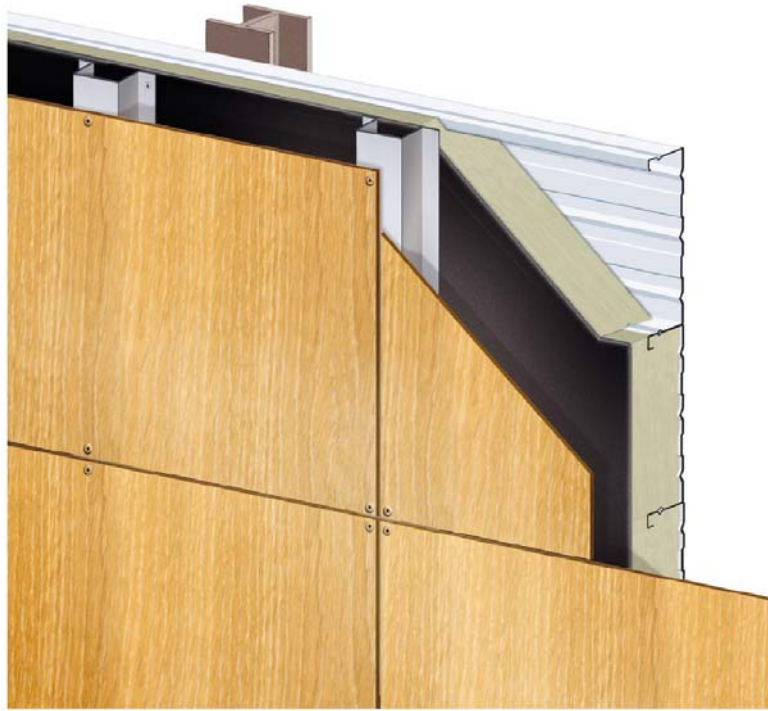
Figure 2 – Schéma de principe panneaux avec pare-pluie synthétique
